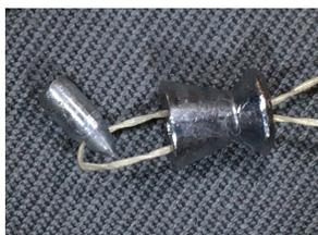
写真 1.3 ペレットを糸で銃口から引っ張るための仕掛け
