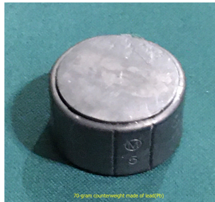
写真2 70-gram Pb エアシリンダー先端に被せるやうに取り付ける
