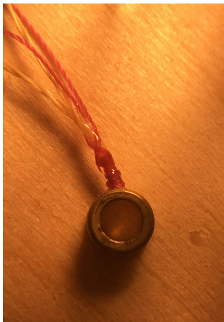
Fig 1.1b ケヴラー糸をヴァイオリンの“ボール”に巻きつけた様子
