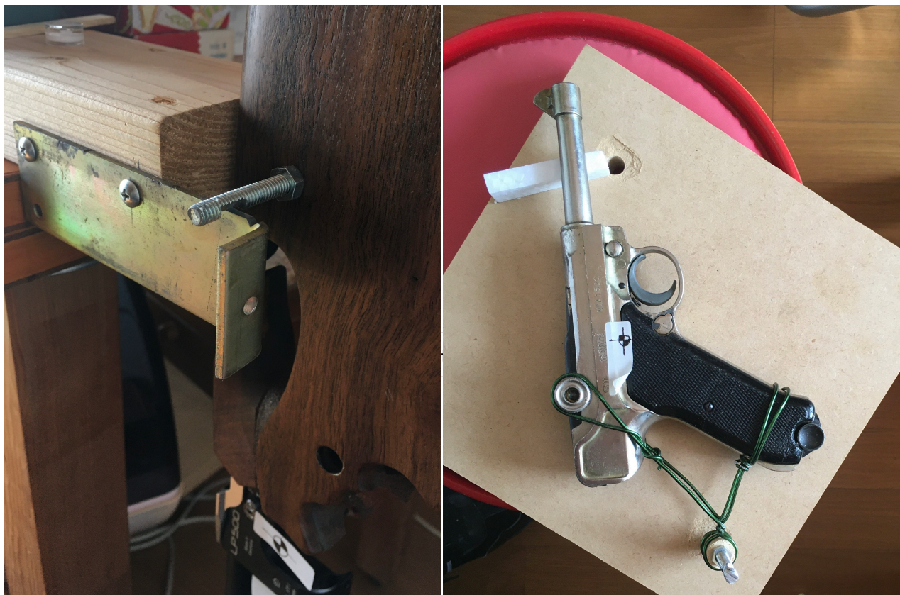
Fig. 1.2.1a(左) 軸受と LP500 ハンドライフルのストックに穴を開けて通した軸
