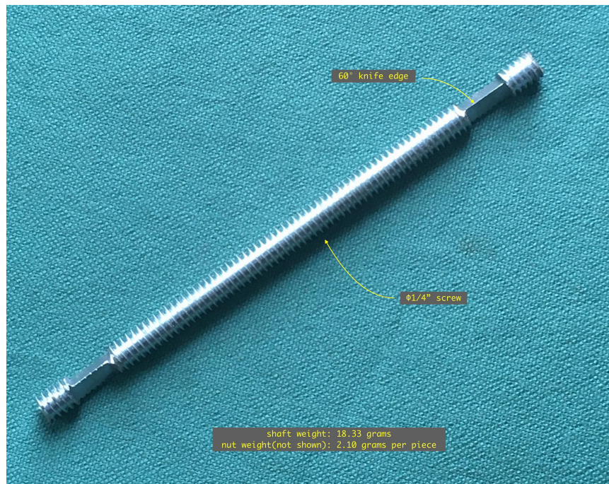
Fig. 1.1a 2 個の 60° ナイフエッジ Pivot を持つ 1/4inch ネジを加工して作った軸 この部品は質量が 2.10grams もあるが芯から半径 3mm 以内に質点が分布してゐるので慣性 モーメント測定では無視できる.
