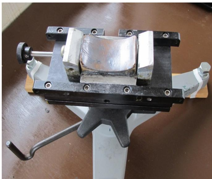
図4 レスト前部 ストックを受ける部分の RはストックのRと同じ
